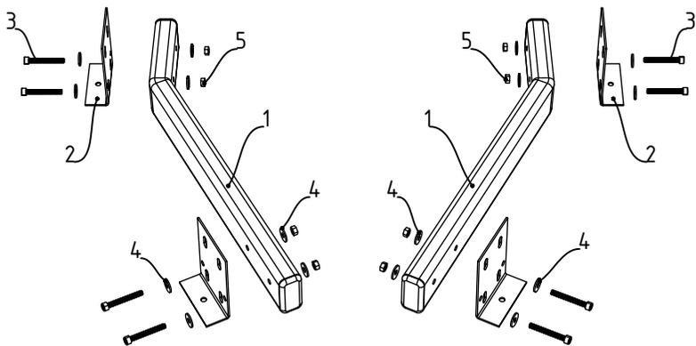
Рис. 1. Составные элементы комплекта опор для завес ЗВП-М1/М2
