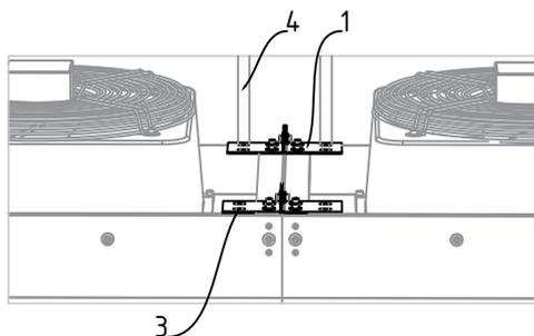
4. Обязательно, при установке над проемом группы воздушных завес произвести крепление стыка завес к несущей конструкции. Крепление можно выполнить с помощью монтажных шпилек М8. Окончательный вид крепежа выбирается инженером-конструктором при проектировании.
