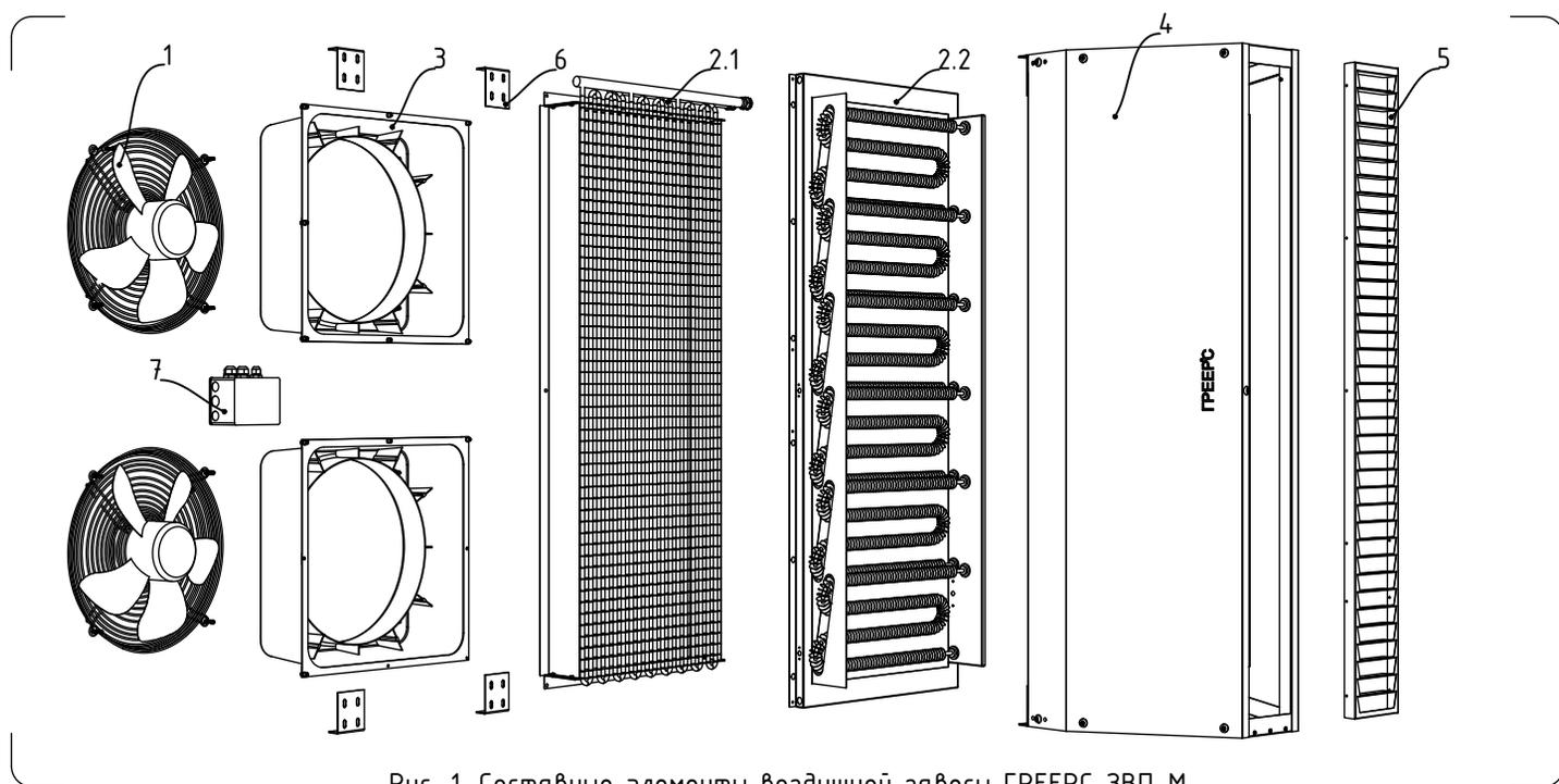
Рис. 1. Составные элементы воздушной завесы ГРЕЕРС ЗВП-М
