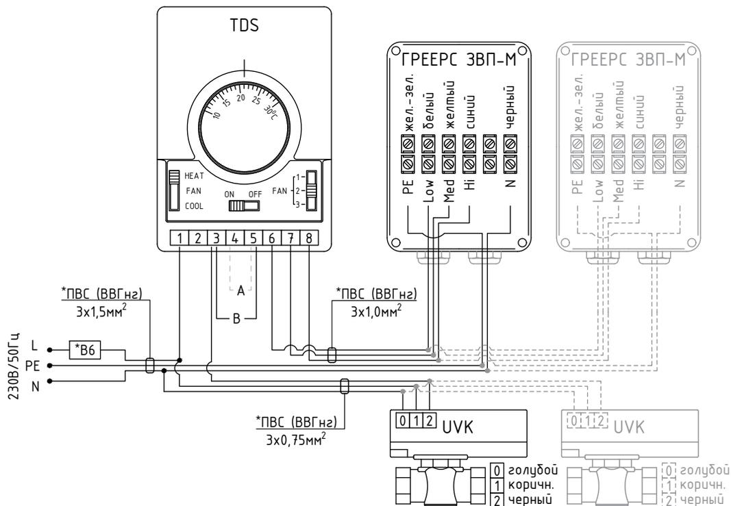
FAN CONT (A) – постоянная работа вентилятора независимо от температуры
