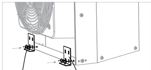
1. Установка крепежных держателей на воздушной завесе с помощью винтов М6, поставляемых совместно с завесой.
