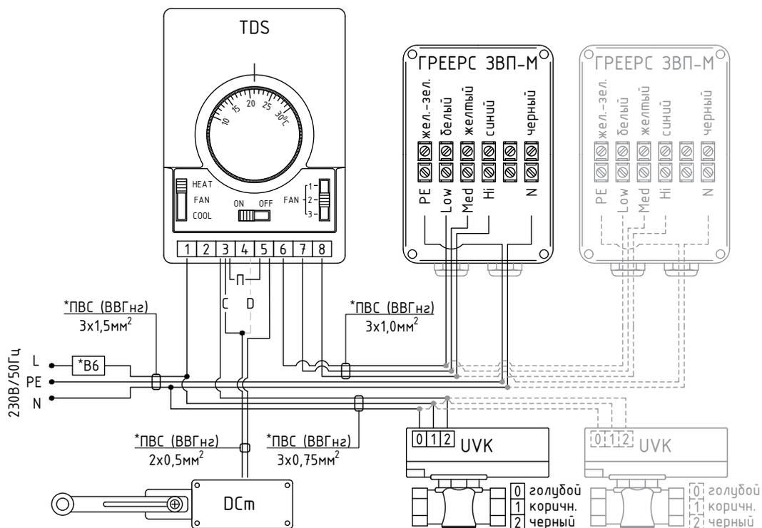
Вариант подключения С - при открытии дверей срабатывает датчик DCM. Включение завесы и открытие клапана происходит в зависимости от срабатывания термостата TDS.
