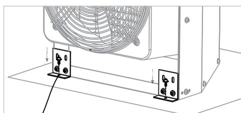
2. Установка воздушной завесы на проектное место, фиксация ее к полу через крепежные держатели.
