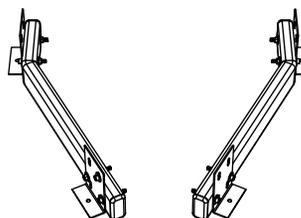
3. Установить завесу на опоры, перед этим открутив винты и транспортировочные крепления
