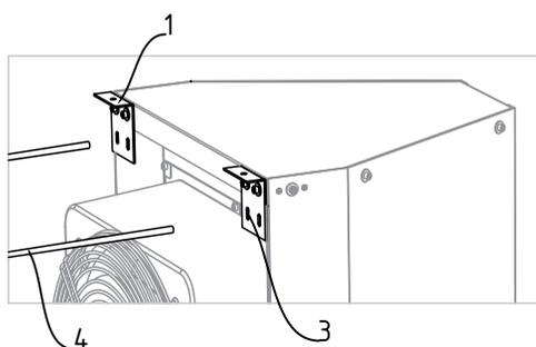
4. Фиксация верха воздушной завесы с помощью крепежных держателей соединенных с опорой через монтажную шпильку или другой несущий элемент (вид крепления выбирается инженером-конструктором при проектировании).
