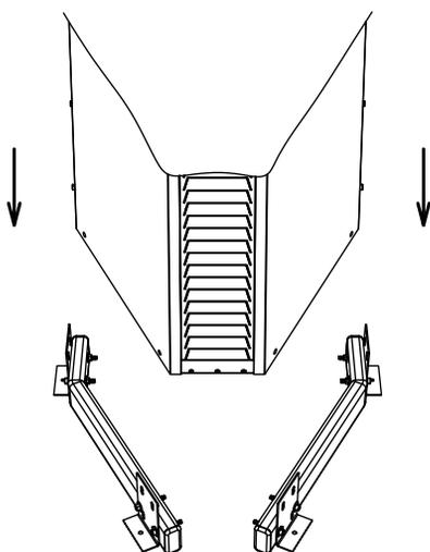
4. Зафиксировать завесу на опорах с помощью винтов крепления транспортировочных опор
