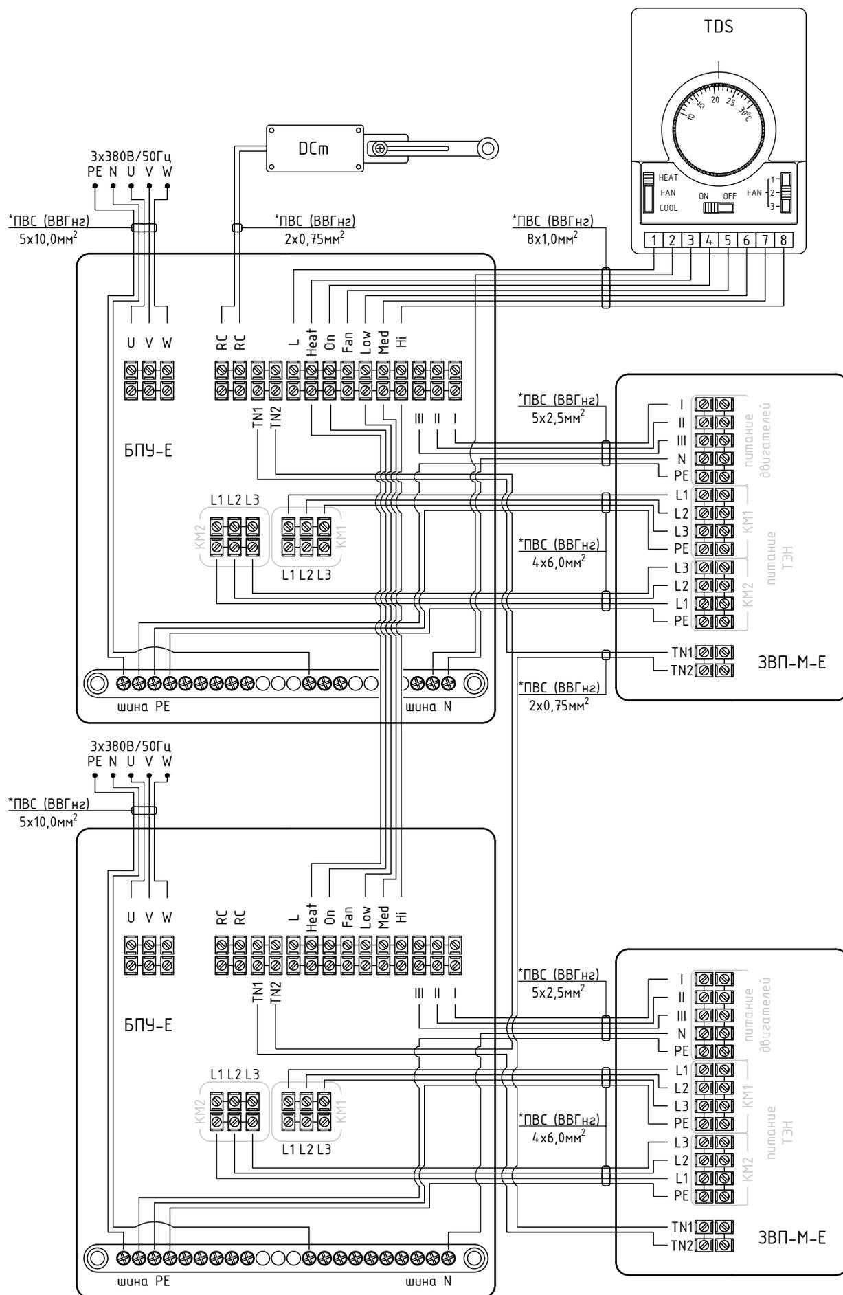
Блок питания и управления БПУ-Е предназначен для комплексного управления промышленными воздушными завесами ГРЕЕРС ЗВП-М-Е и обеспечивает пуск, остановку и защиту подключаемых завес.
