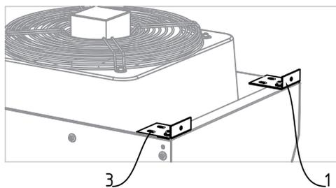
2. Рекомендуем осуществить монтаж воздушных завес над проемом с помощью крепежных держателей и монтажных шпилек М8. Вид крепления выбирается инженером-конструктором при проектировании.
