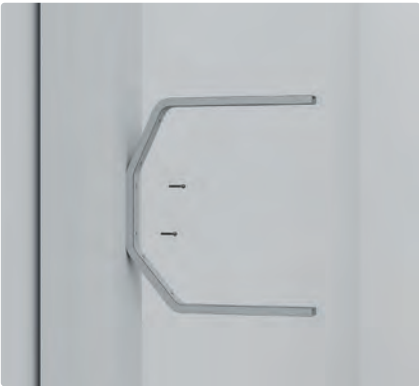
Расстояние между отверстиями: для 1 типоразмера – 100 мм для 2 и 3 типоразмеров – 120 мм
