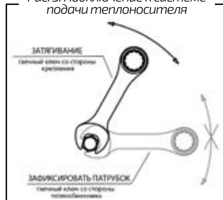
Рис. 3. Подключение к системе подачи теплоносителя
