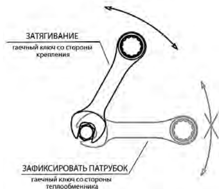
Рис. 5. Подключение к системе подачи теплоносителя
