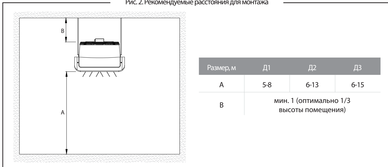
Рис. 2. Рекомендуемые расстояния для монтажа
